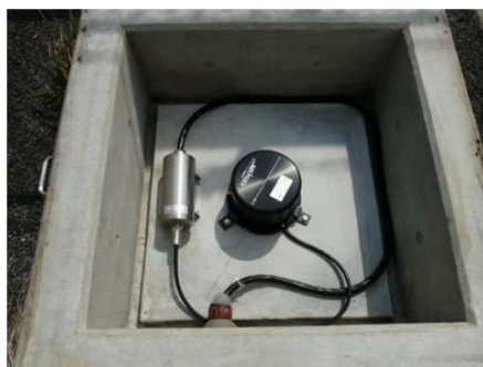
計測震度計感部
